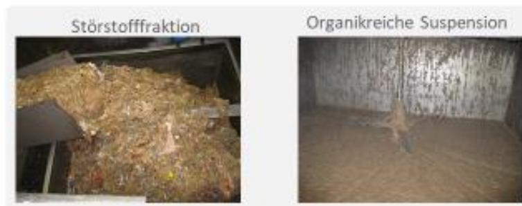
Abbildung 12: Outputstoffe des Tietjen DRM-Hybrid Systems
